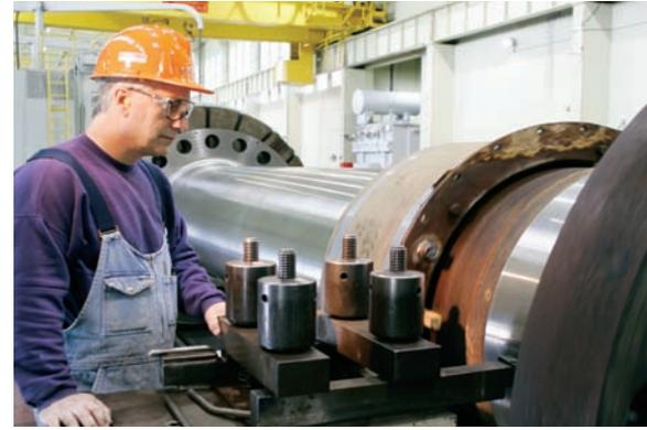
Doug Douma, **technicien mécanicien d'OPG**, nettoie un arbre de turbine dans le cadre des travaux de remise à neuf de l'unité de production 14 de la centrale hydroélectrique Beck 2 à Niagara Falls. Ces travaux font partie d'un important programme à long terme de mise à niveau des 16 unités de la centrale, qui a commencé en 1996 et qui devrait se terminer en 2005. Une fois le programme terminé, la centrale offrira une capacité additionnelle de 194 MW.
